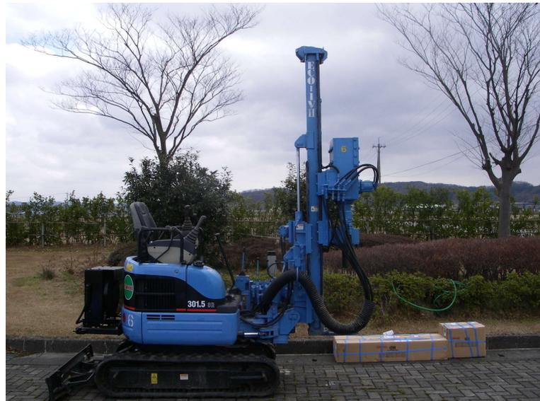
写真-3 ドレーン打設機 (DN-3)
