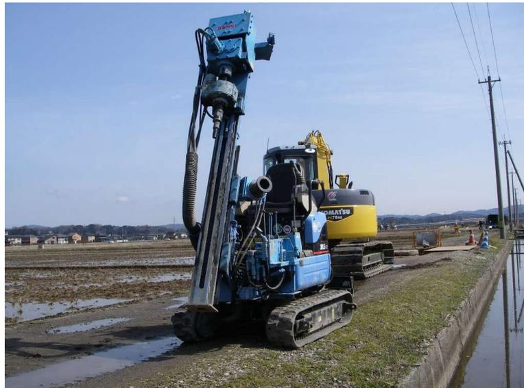
写真-2 ドレーン打設機 (DN-2)
